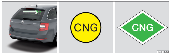
Obr. 319 Umístění štítku CNG / Štítek CNG
