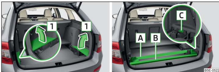
Obr. 152 Vyjmutí bočních krytů zavazadlového prostoru / Uložení střešních nosičů
