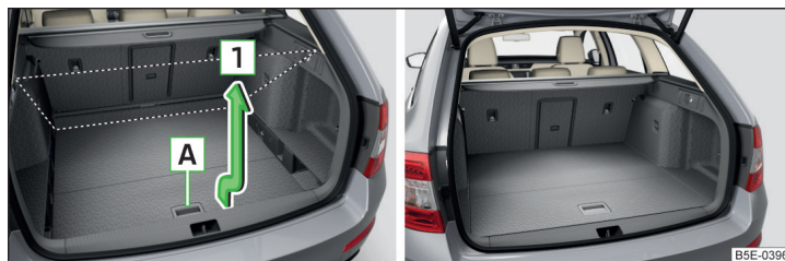
Obr. 144 Nastavení mezipodlahy do horní polohy / Mezipodlaha v horní poloze
