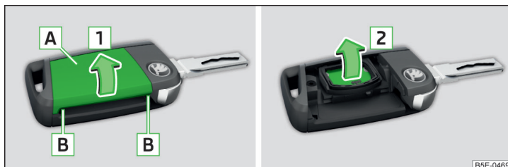
Obr. 345 Odklopení krytu / Vymutí baterie
