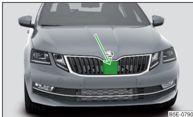
Obr. 251 Umístění radarového snímače
