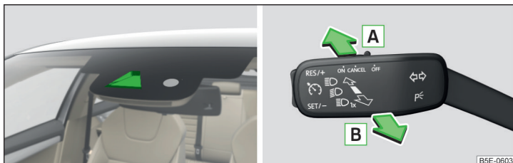
Obr. 69 Okénko snímáče pro Asistent dálkových světel / Zapnutí/vypnutí systému
